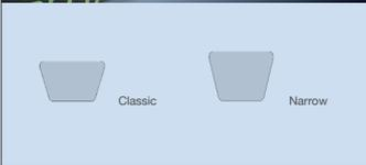
Les courroies trapézoïdales Delta sont disponibles dans toutes les tailles. Elles se distinguent en deux profils différents:
