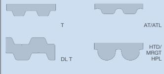
Les courroies GATES Synchro-Power® en polyuréthane, sont conçues pour durer et offrir des performances énergétiques efficaces tant en transmission de puissance qu'en transmission de mouvement. Elles sont fabriquées dans différentes versions sans fin et à bouts libres, disponibles dans plusieurs dimensions, constructions et formes de dents répondant ainsi à une large gamme de charges, vitesses et applications.
