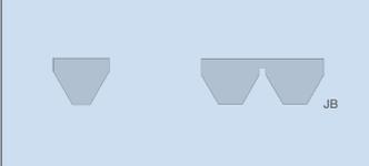
La courroie trapézoïdale en polyuréthane Polyflex® de GATES permet une transmission de force élevée avec un encombrement réduit. Elle associe une capacité de charge supérieure et des vitesses élevées sur les entraînements de précision compacts, à rainures multiples, ce qui conduit à des économies de coûts importantes et à une plus grande liberté en matière de conception de l'entraînement.
