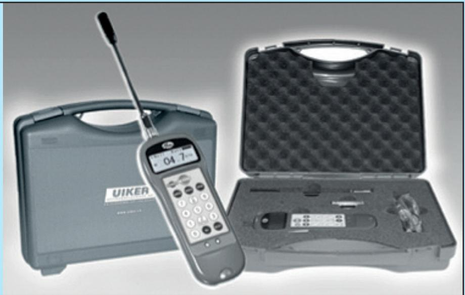
Die Leistungsfähigkeit eines Antriebs ist in hohem Masse von der richtigen Spannung des Keil- oder Synchronriemens abhängig. Der 508C Sonic-Vorspannungsprüfer ermöglicht eine einfache und exakte Spannungsmessung mittels Analyse der vom Riemen übertragenen Schallwellen (natürliche Frequenzen).
