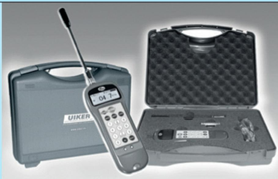
Les performances d'un entraînement dépendent dans une grande mesure de la tension d'installation correcte de la courroie crantée ou de la courroie synchrone. Le tensiomètre 508C Sonic permet de contrôler la tension d'installation d'une courroie de façon simple et exacte en analysant les ondes sonores transmises par la courroie (fréquences naturelles).
