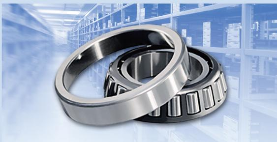
TIMKEN bietet als Erfinder des Kegelrollenlagers das weltweit umfangreichste Sortiment an. Durch ihre einzigartige Bauweise werden Kegelrollenlager speziell dort eingesetzt, wo eine grosse Steifigkeit und hohe Führungsgenauigkeit gefordert ist. Neben einreihigen Lagern (TS) werden zwei- und vierreihige Lagereinheiten mit voreingestellter Anstellung angeboten. Diese sind besonders montagefreundlich und wirtschaftlich.
