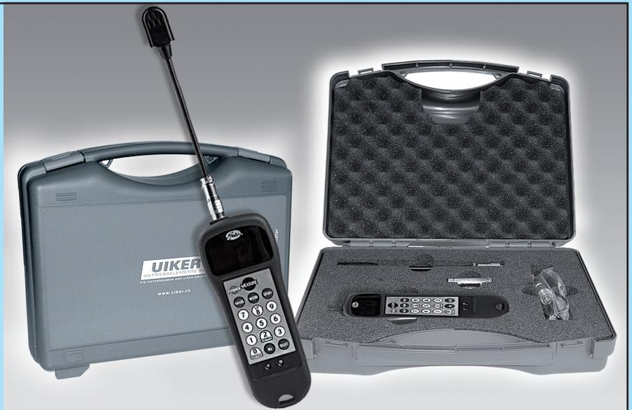
Die Leistungsfähigkeit eines Antriebs ist in hohem Masse von der richtigen Spannung des Keil- oder Synchronriemens abhängig. Der 550C Sonic-Vorspannungsprüfer ermöglicht eine einfache und exakte Spannungsmessung mittels Analyse der vom Riemen übertragenen Schallwellen (natürliche Frequenzen).
