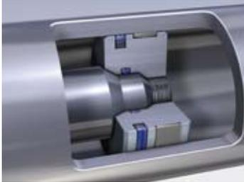
Kolbendichtungen (nach ISO 7425) ermöglichen die gewünschte Bewegungsrichtung der Kolbenstange. In der Regel werden doppeltwirkende Dichtungen eingesetzt, die von beiden Seiten druckbeaufschlagbar sind.
